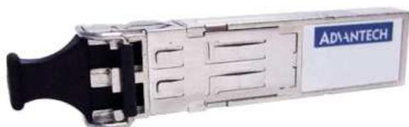
PRA-SFPSX 是適用於多模光纖的精簡型光纖收發器，可涵蓋長達 550 公尺的距離。此光纖收發器為 OEM 收發器，由 Advantech 專為 Bosch 所打造，適用於 Bosch 公共廣播及語音警報系統。它會鎖入 PRAESENSA 多功能電源供應器和乙太網路交換器的 SFP 插座中。它符合快速乙太網路和 IEEE 802.3z Gigabit 乙太網路標準，可提供出色的效能、可靠性和靈活性。PRA-SFPSX 搭配 PRAESENSA 系統的使用已經過 EN 54-16 認證。
