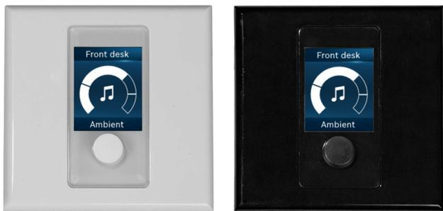
墙装控制面板PRA-WCP-EU能够在PRAESENSA音响系统覆盖的分区内对背景音乐(BGM)进行便捷的本地控制。通过PRAESENSA系统, 可以为每个墙装控制面板配置一组可选择的音乐源、音量控制范围和操作分区。控制快速直观, 只需一个旋钮即可进行旋转和按下所选操作。彩色LCD提供清晰的用户反馈。可以使用PIN码管理用户访问, 以便限制仅授权人员能操作。
