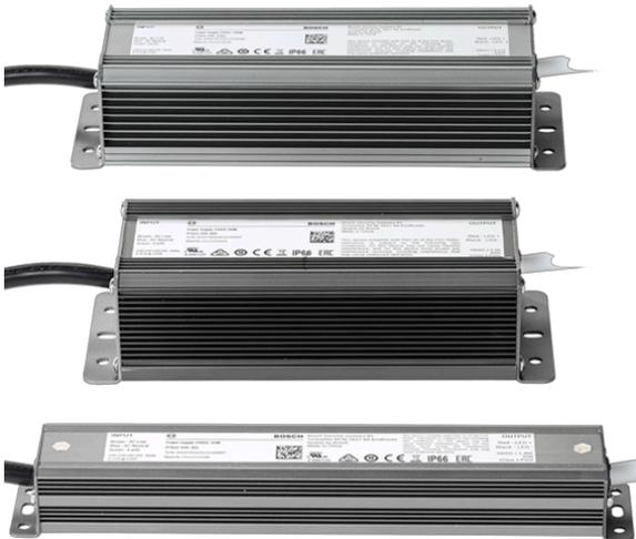
PSU-IIR 裝置是恆壓、24 VDC 電源，專為 LED 照明應用而設計，具有短路、過壓、電流過載和過熱保護功能。每個單元均包含 200 公釐 (8 吋) 輸入/輸出飛線的纜線連接。提供 35 W、60 W 或 100 W 機型。
