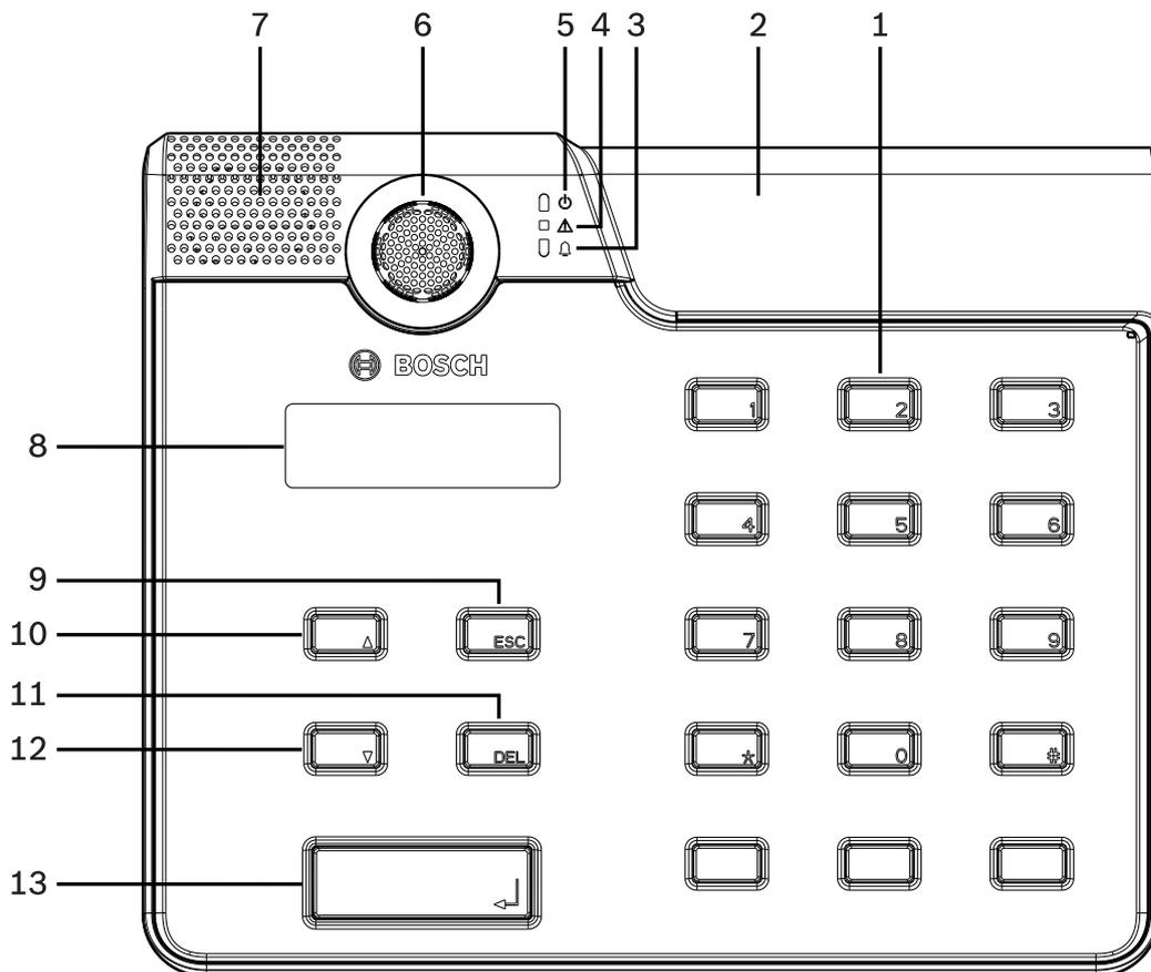
Abbildung 3.1: Draufsicht der PMX-15CST Sprechstelle
