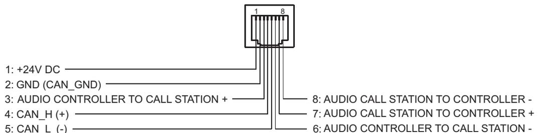
**Abbildung 6.1:** Belegung des CST-Bus-Anschluss
