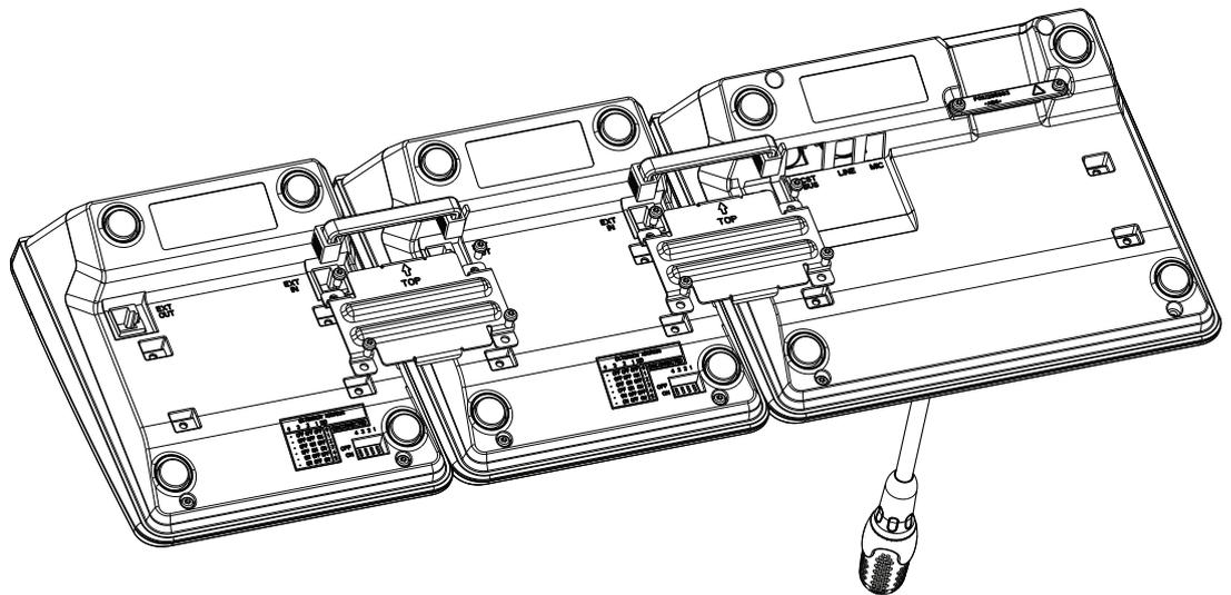
4. Stecken Sie das Anschlusskabel in die EXT-Buchse der Sprechstelle bzw. Sprechstellenerweiterung ein (der Stecker rastet mit einem "Klick" ein).
