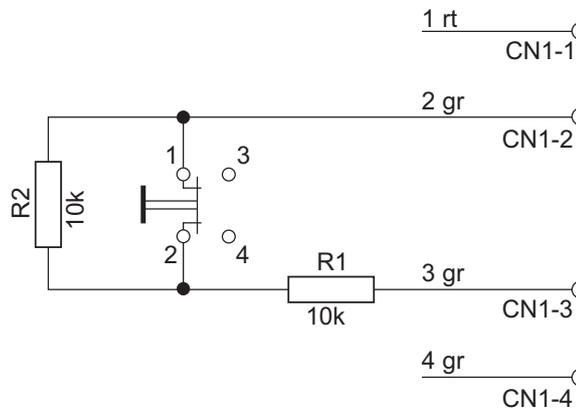
9. Die Anschlussreihenfolge des Flachbandkabels ist zu beachten. Die beiden außen liegenden Leitungen 1 (rot) und 4 (grün) sind möglichst kurz an der Trennstelle abzuschneiden und zu isolieren. Die beiden innen liegenden Kabel 2 (grün) und 3 (grün) sind an die Schalteranschlüsse 1 und 2 anzulöten. Die Polarität spielt dabei keine Rolle.
