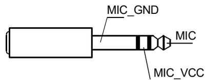
**Abbildung 6.5:** Belegung des MIC-Steckers
