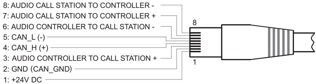
**Abbildung 6.2:** Belegung des CST-Bus-Stecker
