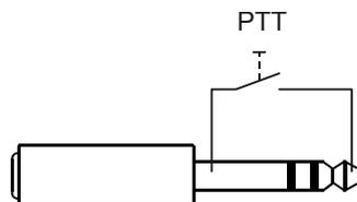
**Abbildung 6.4:** Belegung des LINE-Steckers als Sprechstasten-Kontakteingang (PTT)
