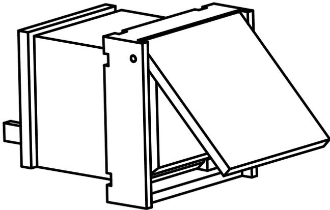
Die PVA-1EB ist eine optionale Notfalltaste zum Einbau in die PAVIRO Sprechstellen. Weitere Informationen finden Sie in der Bedienungsanleitung der Sprechstelle.
