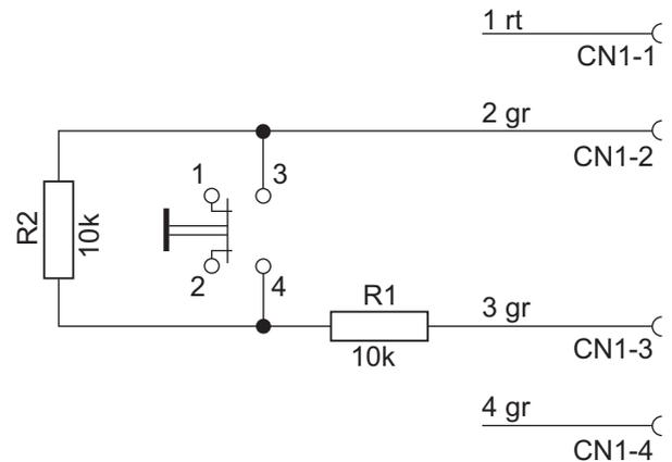
Fig. 2: Conexión del interruptor de llave como contacto normalmente abierto (NA) para propósitos especiales
