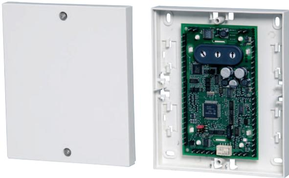
Устройство постановки на охрану SmartKey SE 320 LSNi с подключаемой кодонаборной клавиатурой / считывателем или только с кодонаборной клавиатурой представляет собой решение для постановки / снятия с охраны систем охранной сигнализации.
