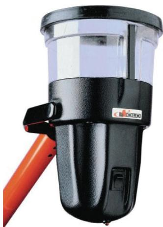
Тестовый комплект теплового извещателя SOLO461 работает от батарей и направляет поток нагретого воздуха на сенсоры теплового извещателя. Он использует запатентованную систему с технологией CAT™ (Cross Air Technology) для концентрации воздуха и горизонтального направления его на сенсор, независимо от размера и формы извещателя.
