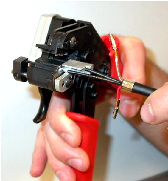
Abbildung 6.80: Zuschneiden eines LWL (1)
