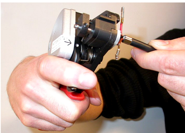
Abbildung 6.82: Zuschneiden eines LWL (3)
