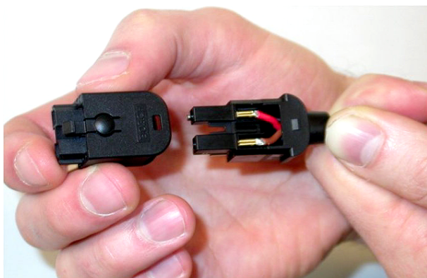
Abbildung 6.99: Montage des vorderen Gehäuseteils
