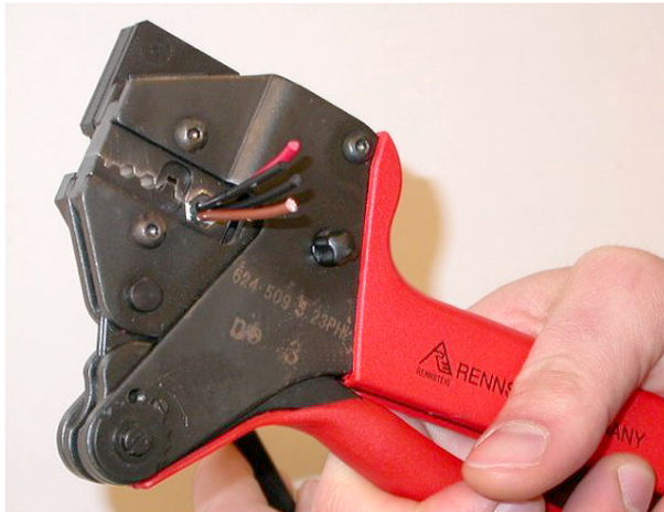
Abbildung 6.73: Crimpen der Hülse
