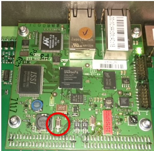
Abbildung 7.7: Nicht sichere Einstellung der PRIS-4OMI4 PCB
