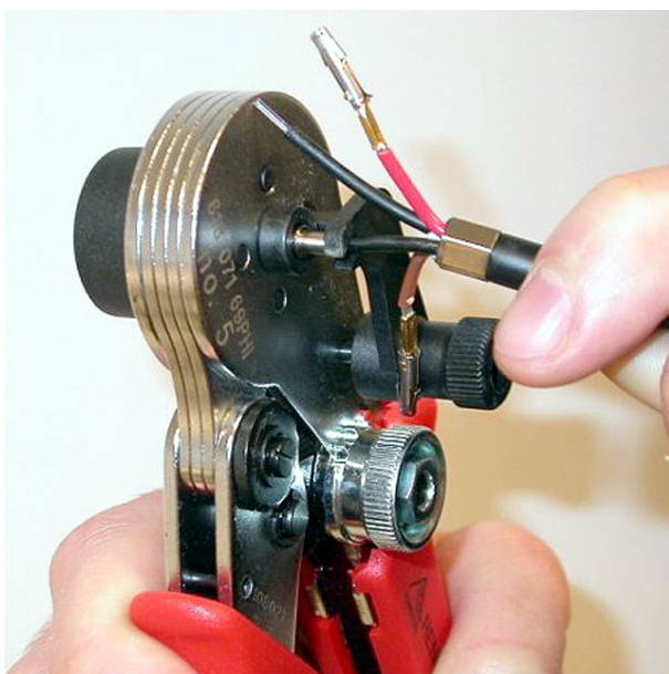
Abbildung 6.87: Crimpen von Ferrulen (1)
