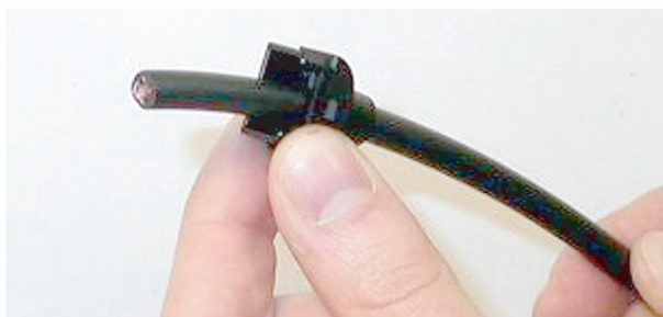
Abbildung 6.70: Hinteres Gehäuseteil auf Kabel
