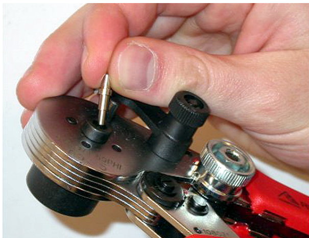
Abbildung 6.85: Einsetzen einer Ferrule
