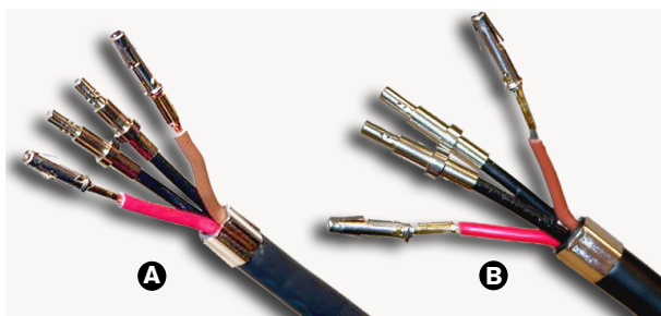
Kuva 6.90: Ferriittiholkit kuitujen päällä
