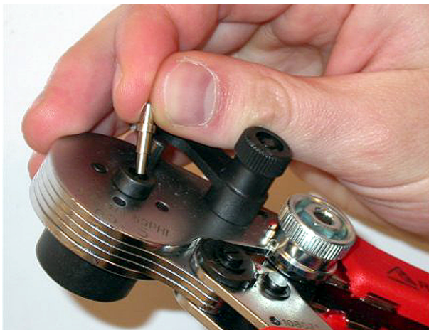
Afbeelding 6.85: Een flensbusje plaatsen
