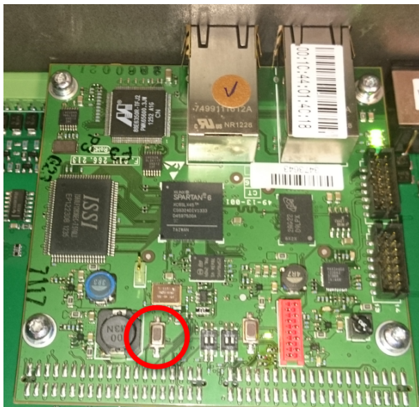
Afbeelding 7.7: Niet-veilige instelling op printplaat van PRS-4OMI4
