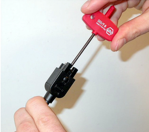
Рис. 6.101: Затяжка винта Torx
