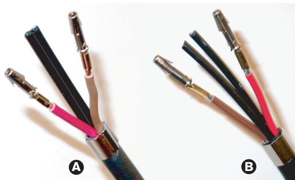
Рис. 6.79: Смонтированные контакты разъема
