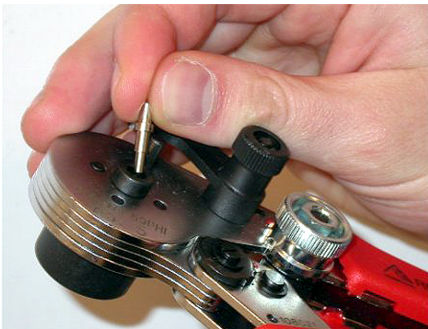
Рис. 6.85: Вставка обжимного наконечника
