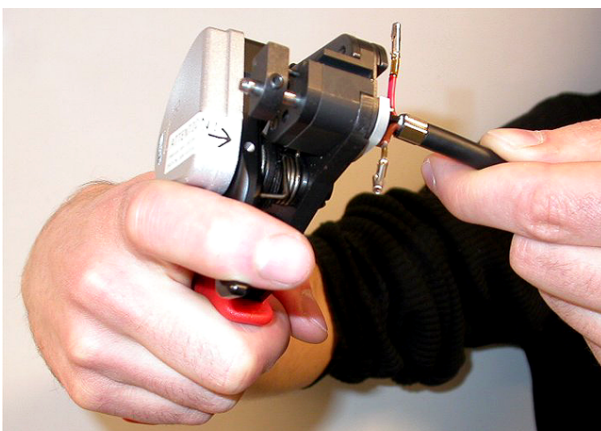
Рис. 6.82: Обрезка волоконного световода (3)
