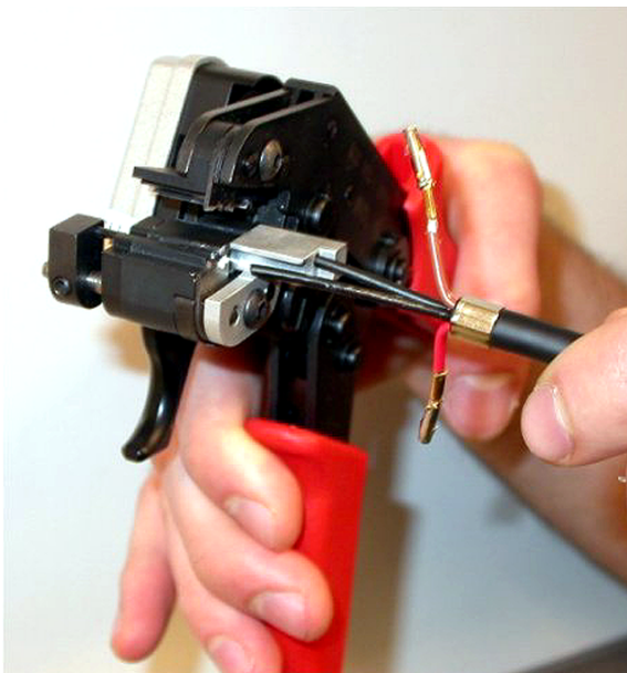
Рис. 6.80: Обрезка волоконного световода (1)
