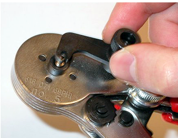
Рис. 6.86: Вставка обжимного наконечника
