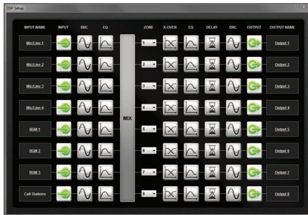
Abbildung 7.2: Setup-Bildschirm der DSP-Matrix-Mixer-GUI
