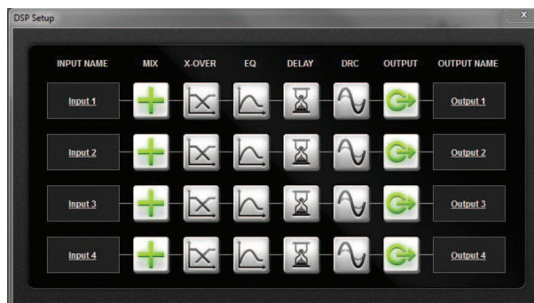
Abbildung 7.4: DSP Setup-Bildschirm der Verstärker-GUI
