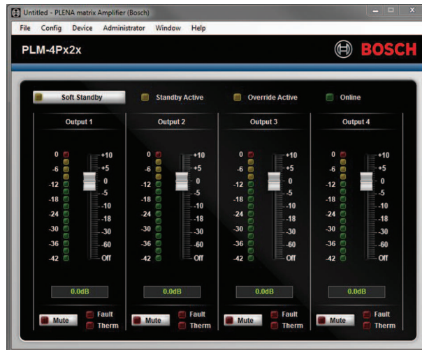
Figura 7.3: Pantalla principal del software GUI del amplificador - Niveles de salida para cada canal del amplificador. - Supervisión de fallos. - Silencio por canal del amplificador. - Conexión al dispositivo.
