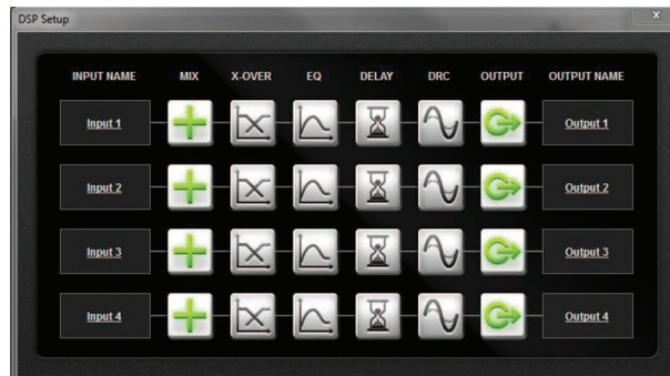
Figura 7.4: Pantalla de configuración de DSP del software GUI del amplificador - Mezclador con entrada. - Transmisión. - Ecuador paramétrico (incluida la activación/desactivación de la optimización de graves). - Retardo. - Compresión de rango dinámico (DRC). - Control de nivel de salida.
