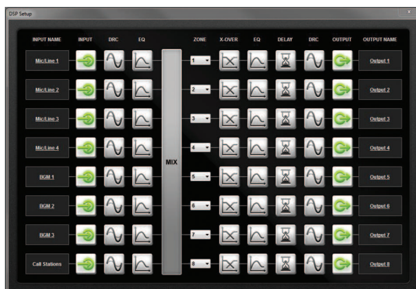
Rysunek 7.2: Mikser z procesorem DSP systemu Matrix — strona konfiguracji programu interfejsu GUI
