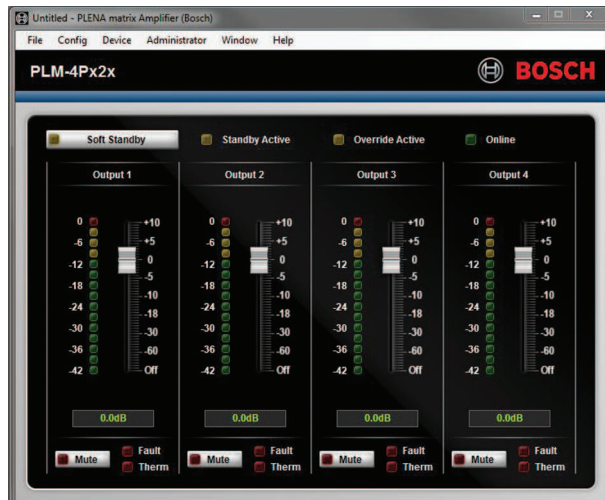
Rysunek 7.3: Ekran główny oprogramowania interfejsu GUI do obsługi wzmacniacza
