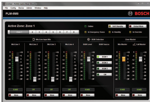
Rysunek 7.1: Mikser z procesorem DSP systemu Matrix — strona główna programu interfejsu GUI
