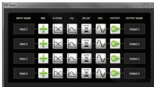
Rysunek 7.4: Ekran konfiguracji oprogramowania interfejsu GUI do obsługi wzmacniacza z procesorem DSP
