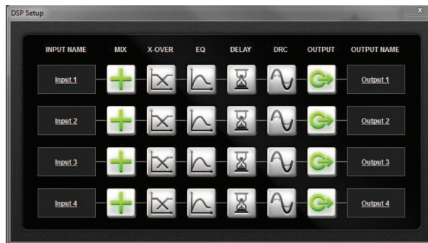
รูปภาพ 7.4: หน้าจอการตั้งค่า GUI DSP เครื่องขยายสัญญาณเสียง
