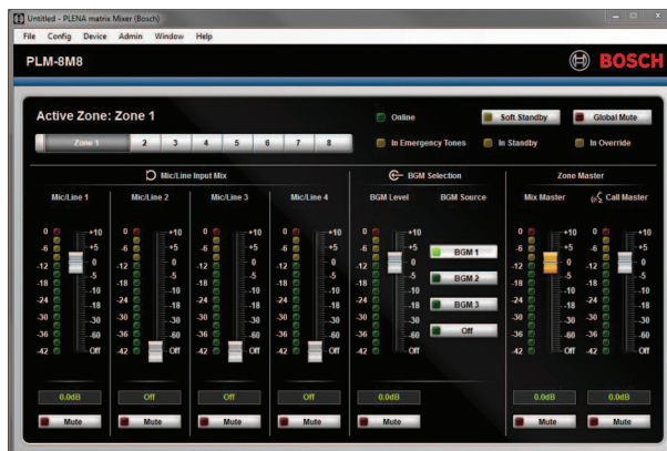
รูปภาพ 7.1: หน้าจอหลัก GUI ตัวประมวลผลสัญญาณดิจิทัล DSP Matrix Mixer
