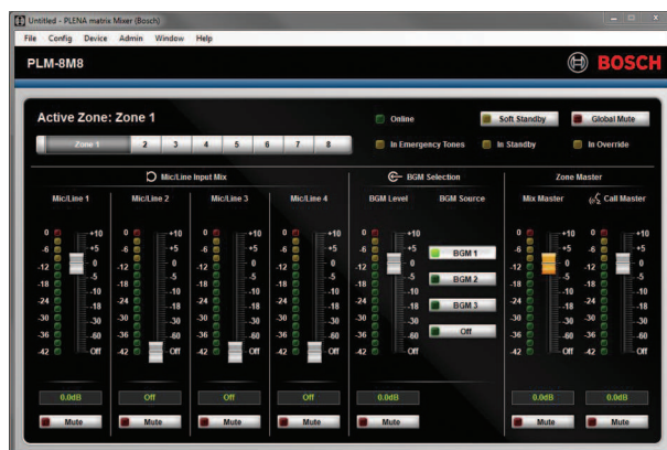
Hình 7.1: Màn hình chính GUI của bộ trộn ma trận DSP
