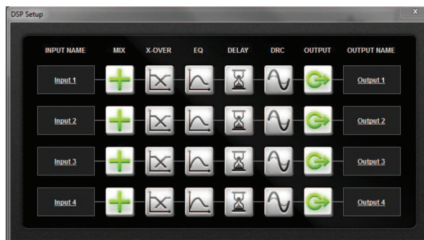
Hình 7.4: Màn hình cài đặt GUI DSP của bộ khuếch đại
