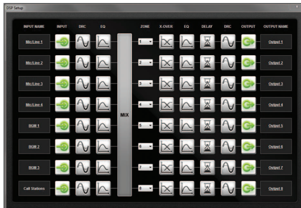
Hình 7.2: Màn hình cài đặt GUI của bộ trộn ma trận DSP
