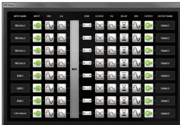
图片 7.2: DSP 矩阵混合器 GUI 设置屏幕
