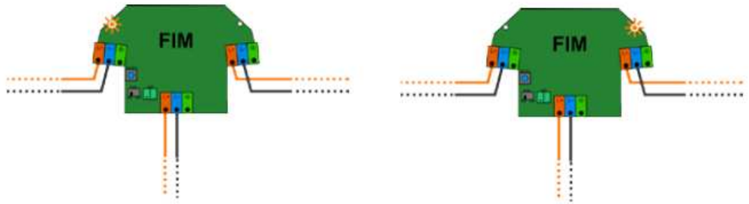
Kortsluiting aan kant A
