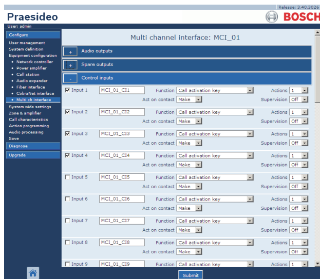
abbildung 44.25: Steuereingänge für Mehrkanalschnittstelle
