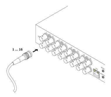
Можно подключить к кодеру VIDEOJET multi 4000 до 16 видеоисточников. Для этой цели подходят любые камеры и другие источники видеосигнала, которые могут генерировать сигнал в формате PAL или NTSC.
