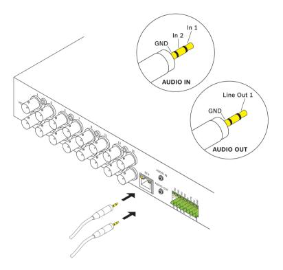
Устройство оснащено двумя аудиопортами для линейных аудиосигналов.
