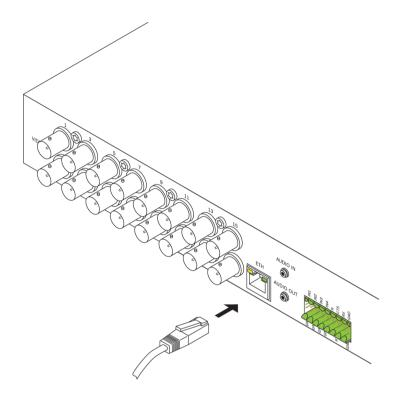
Можно подключить устройство к сети 10/100/1000 Base-T при помощи стандартного кабеля НВП категории 5 с разъемами RJ-45.
