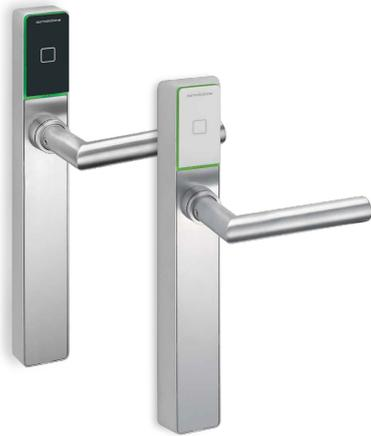
Der c-lever pro ist ein schloss- und zylinderunabhängiger, im Standard beidseitiger, elektronischer Türbeschlagsleser mit integrierter Kupplung.
